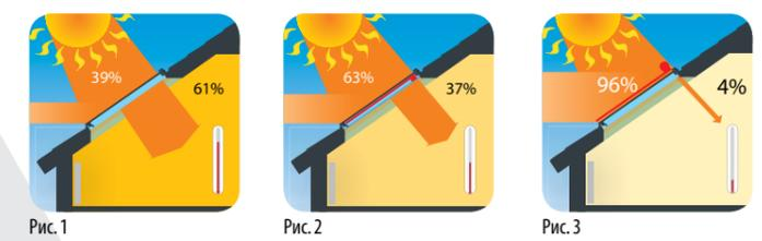
Коэффициент суммарного количества пропускаемой солнечной энергии (g) отображает процент солнечной энергии, проникающей внутрь помещения. Чем выше значение коэффициента (g), тем быстрее нагревается помещение. Наружная маркиза защищает помещение от нагревания **в 8 раз эффективнее**, чем внутренняя штора.
